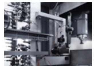
Werkzeugmagazin mit 60 Plätzen und kettengetriebenen Servomotoren.
