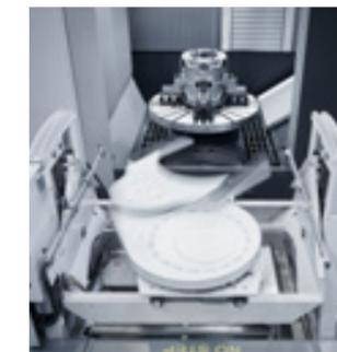
Um die Fertigungszeiten zu minimieren und die Produktivität zu erhöhen, bietet IBARMIA je nach Größe der Maschine verschiedene Palettenwechselsysteme an, die sich optimal an die jeweiligen Produktionsanforderungen anpassen.
