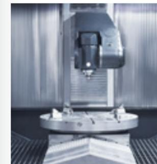
Das gesamte Maschinenprogramm, bestehend aus fünf Baugrößen und zwei stufenlose NC-Schwenkköpfen und fest eingebauten NC-Rundtisch, richtet sich an allen Kunden, die große Werkstücke in einer einzigen Aufspannung bearbeiten wollen.
