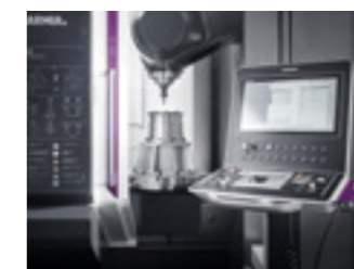
Bedienfeld mit 19"-Touchscreen. Auswahl der wichtigsten Hersteller: HEIDENHAIN, FANUC, SIEMENS.
