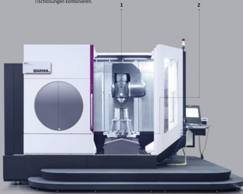
Zwei Schwenkopfmodelle sowie eine breite Palette an verfügbaren Lösungen ermöglichen die Anpassung der Maschine an die verschiedensten Produktionsanforderungen.
