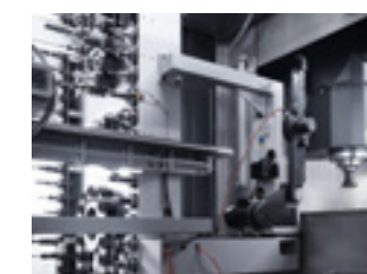
Almacén de cadena vertical servoaccionado de 60 posiciones.
