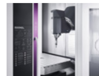
Área de trabajo iluminada. Techos lisos y ausencia de planos horizontales en el área de trabajo.
