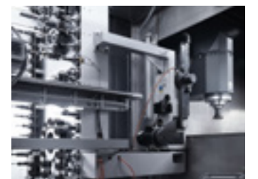
Almacén de cadena vertical servoaccionado de 60 posiciones.
