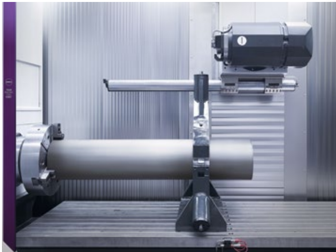
Dank der außergewöhnlichen Steifigkeit und Länge der Bohrstangen ist die Maschine in der Lage, präzise tiefe Innendreharbeiten durchzuführen.
