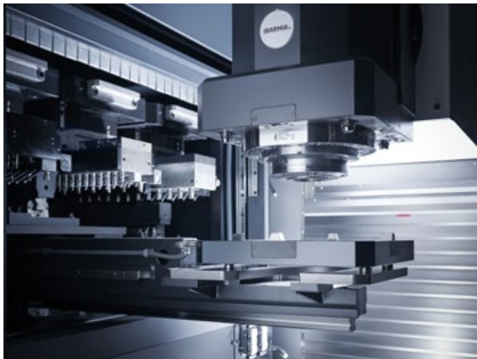
IBARMIA passt den B-Achsen-Kopf für die Aufnahme spezieller Bearbeitungsköpfe an, die automatisch über in die Maschine integrierte Pick-up-Stationen gewechselt und verwaltet werden.
