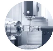
Integrierte Drehtische als A-Achse für horizontale 5-Achs Fräs- und Drehbearbeitungen.
