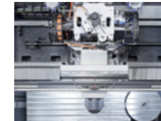
Die Linearachsen werden bei jeder Maschine nach der Norm VDI/DGQ3441 über Laser- Interferometer geprüft, genauso wie die Präzision der Kreisform über Ball-Bar Test.
