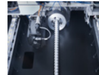
Hochpräzise geschliffene Kugelrollspindel mit vorgespannten Doppelmutter. In der Längs- achse erfolgt der Antrieb über angetriebene Doppelmutter und feststehende Kugelrollspindel.
