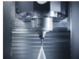
Kühlsystem für interne Kühlung durch die Spindel (22 bar)
