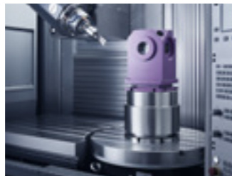
Integrierter Rundtisch ø800 mm (STAR 1500).
