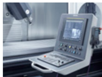
Numerische Steuerung Fanuc 31i-B mittels Touchscreen 19" (vertikale Anzeige im STAR 1500).
