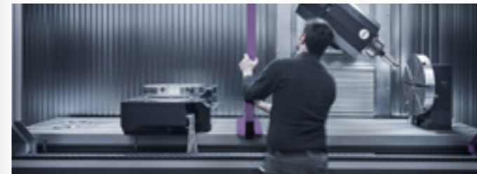
Software „Non stop machining“ mit Trennwand für die Bearbeitung im Pendelmodus (STAR 3000).
