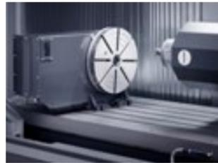
Aufsatz NC-Rundtische mit der Möglichkeit des vertikalen und horizontalen Einsatzes.
