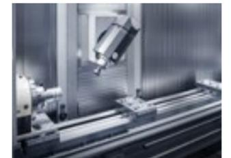
Mobile Tische anstelle des festen Tisches, zur effektiven Bearbeitung von Werkstücken unterschiedlicher Länge.
