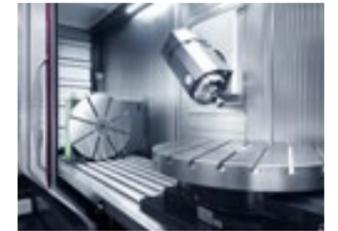
Ein breites Spektrum von aufgesetzte Rundtische bis zu ø800 mm horizontal und Rundtischplatten mit Störkreise bis zu ø1500 mm.
