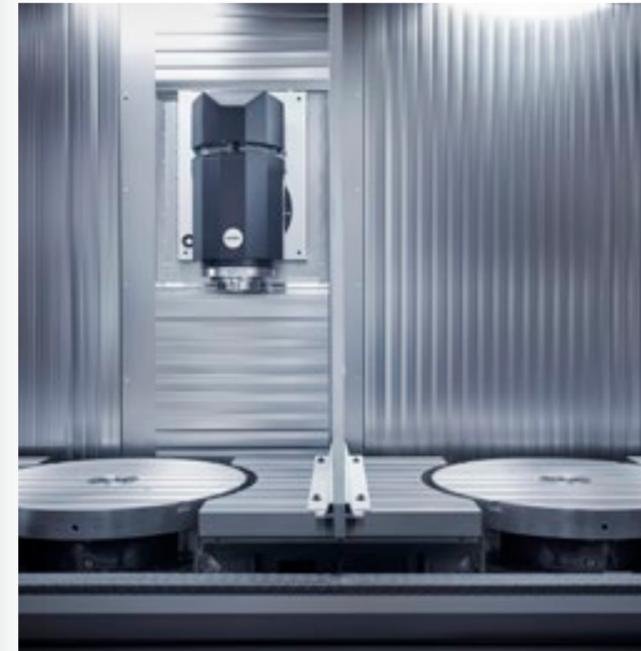
Integrierte Rundtische à la carte: Tische über die gesamte Y-Achse (bis ø1500 mm) und/oder Tische mit Durchmessern bis ø2200 mm für schwere und sperrige Werkstücke (ZVH D auf S. 6)
