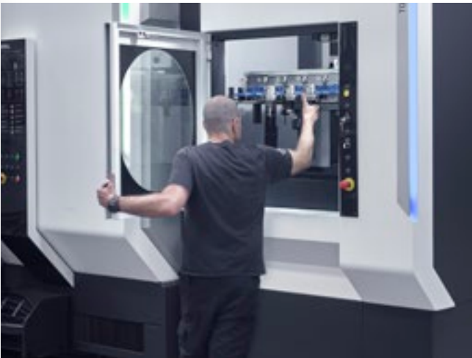
Cette nouvelle conception du système ATC augmente la productivité de la machine en permettant des changements sans risque en dehors de la zone de travail, le chargement et le déchargement du magasin pendant que la machine est en fonctionnement, ainsi qu'un accès facile à tous les éléments de maintenance de la machine.
