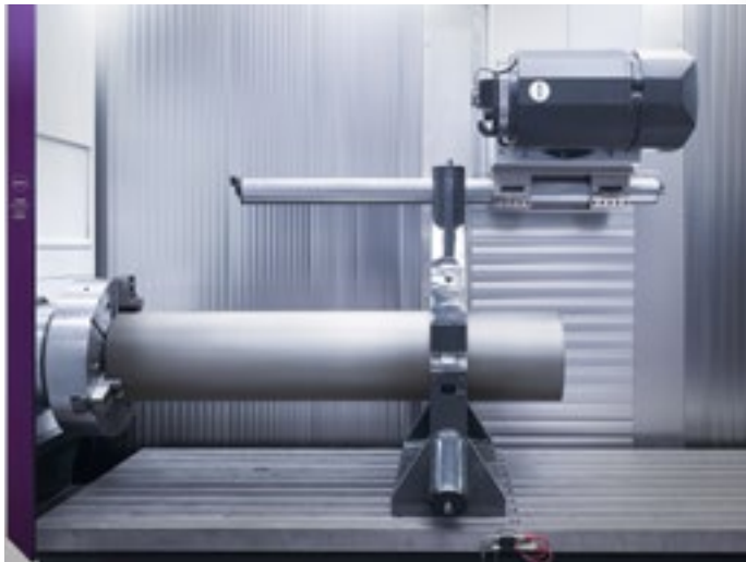
Ces longues barres d'alésage d'une rigidité exceptionnelle permettent à la machine d'effectuer des opérations de rotation intérieur.
