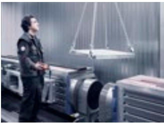
Toit rabattable standard permettant de charger et décharger facilement les pièces à l'aide d'une grue. (Standard)
