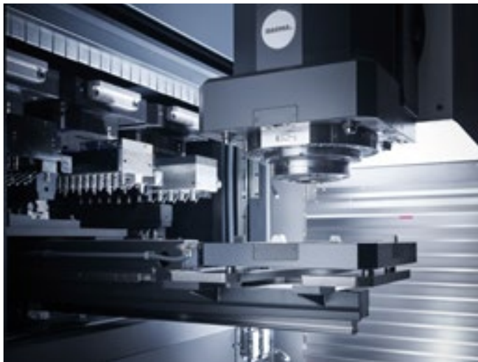
IBARMIA adapte la tête de l'axe B pour accueillir des têtes spéciales pouvant être gérées automatiquement par des stations de prélèvement intégrées à la machine.
