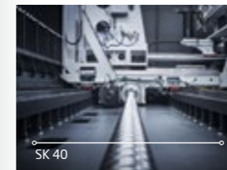
Electrohusillo #40 Potencia en S1 (100%); S6 (40%) 30 kW / 50 kW Potencia total disponible desde 2000 rpm Par en S1 (100%); S6 (40%) 130 Nm / 200 Nm Velocidad máxima (r/min.) 12.000 rpm
