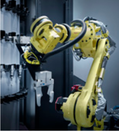
GROSSE POLARE WERKZEUGMAGAZINE MIT GROSSEM FASSUNGSVERMÖGEN Flexible Lösung mit Roboter für Sonderwerkzeuge und Kopfsysteme.
