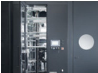
INTEGRIERTE PICKUP MAGAZINE Für die Beherbergung von langen und/oder schweren Werkzeugen; eine ergonomische und einfache kompakte Lösung, um den Zugriff auf Sonderwerkzeuge zu erweitern.
