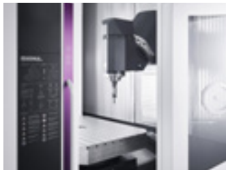
Beleuchteter Arbeitsbereich. Arbeitsraumverkleidung mit glatter Oberfläche und optimiertem vertikalen Spänefall.
