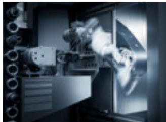
Servoangetriebene Kettenmagazine für 120-240-360 Positionen.
