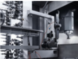
Servoantriebenes Kettenmagazin mit 60 Werkzeugplätzen.
