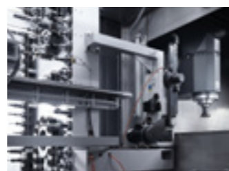
Almacén de cadena vertical servoaccionado de 60 posiciones.
