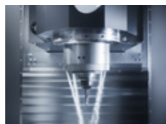
Sistema de refrigeración exterior alrededor del husillo.
