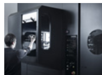
Puesto para provisión manual de herramientas al almacén.
