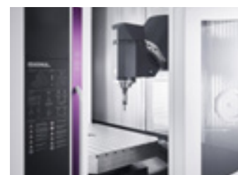
Área de trabajo iluminada. Techos lisos y ausencia de planos horizontales en el área de trabajo.
