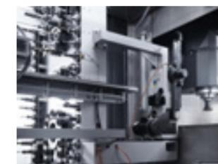
Magasin d'outils à 60 positions avec servomoteurs actionnés par chaîne.
