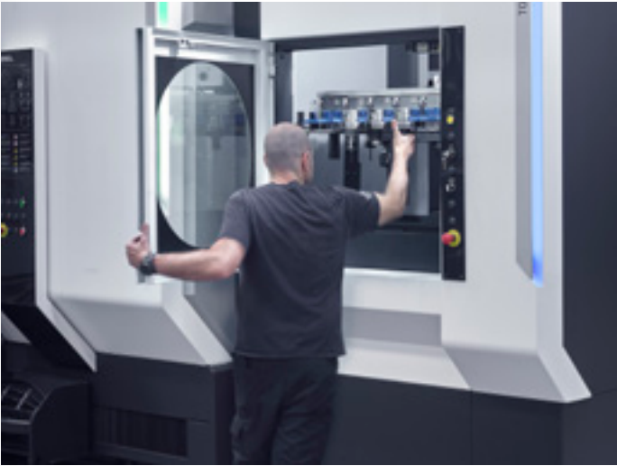
Almacenes concebidos para un incremento de la productividad y eficiencia de la máquina gracias a unos cambios de herramienta seguros fuera del área de trabajo, el hecho de poder alimentar el cambiador mientras la máquina sigue trabajando y ofrecer un acceso directo a los elementos de mantenimiento.
