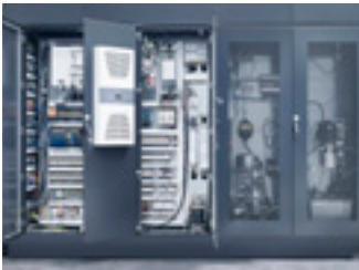
• Armario eléctrico climatizado de fácil acceso. (Estándar). • Sistema de lubricación central programable. (Estándar).
