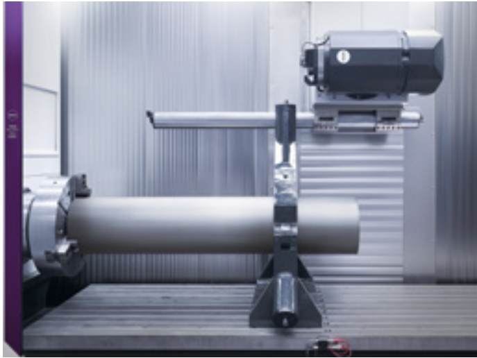
Estas barras de mandrinado de extraordinaria rigidez, habilitan a la máquina para llevar a cabo profundas operaciones de torneado interior.
