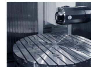
Tische mit Durchmessern bis Ø2200 mm für schwere und sperrige Werkstücke.
