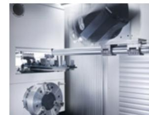
Verfahrbare Pickup-Magazine für die saubere und kollisionsfreie Beherrschung von Sonderwerkzeuggrößen, Winkelköpfen, etc...
