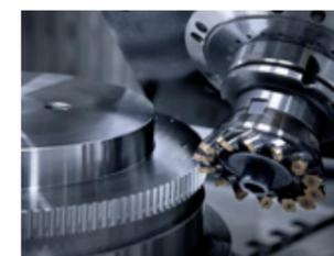
Fortschrittliche Funktionen zur Verzahnungsbearbeitung (Wälzschalen-Wälzfräsen) für Gerad- und Schrägverzahnungen, je nach Maschinenmodell (MULTIPROCESS / EXTREME).
