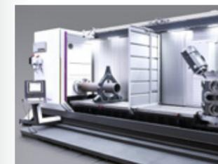
Option „Non Stop Machining“, einschließlich zentraler Trennwand, separater Verriegelung der Fronttüren und Managementsoftware für Arbeiten im Pendelmodus.
