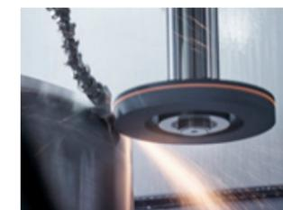
Technologiezyklen für zusätzliche Schleifbearbeitung in der Maschine, je nach Maschinenmodell (MULTIPROCESS / EXTREME).
