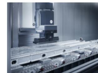
Integration verschiedener Spannsysteme auf dem festen Tisch, wie z.B. Nullpunktspannsystem, Vakuumsystem, usw.
