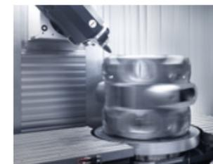
C-Achse integriertes Drehen & Fräsen. Rundtische bis zu einem Störkreis von Ø1500 mm zum Drehen und/oder 5-Achsen Bearbeitungen. Bis zu 6000kg / 800 U/min.
