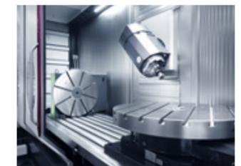
Ein breites Spektrum von aufgesetzten Rundtischen bis zu Ø800 mm horizontal und Rundtischplatten mit Störkreise bis zu Ø1500 mm.
