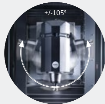
ZVH SPINDELKOPF B-Achse _ 4-Achsen am Fahrständer. Stufenloser NC-Schwenkkopf +/- 105°
