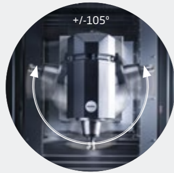
CABEZAL ZVH Eje B_ 4 ejes en punta de herramienta Cabezal de giro continuo con motor torque. +/-105°
