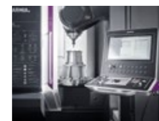
Panel de control con pantalla táctil de 19". Posibilidad de elección entre los fabricantes más prestigiosos: HEIDENHAIN, FANUC, SIEMENS.
