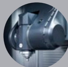
THR_ Cabezal de eje A Cabezal horquilla para mecanizado de ángulos negativos -45°/+135°
